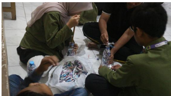
Gambar 3. Proses mengisi botol plastik dengan limbah untuk menghasilkan Ecobrick padat.
