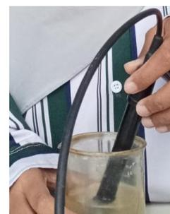
Gambar 1. Pengukuran TDS menggunakan TDS meter
