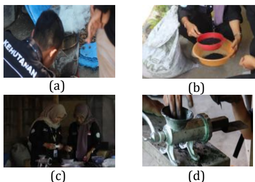
Gambar 3. Proses pembuatan briket arang sach a inchi: (a) Pembakaran kulit sach a inchi, (b) Penumbukan, (c) Pencampuran serbuk arang dengan perekat, (d) Pengepresan
